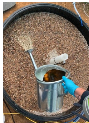
a) expérience d'injection du LNAPL
