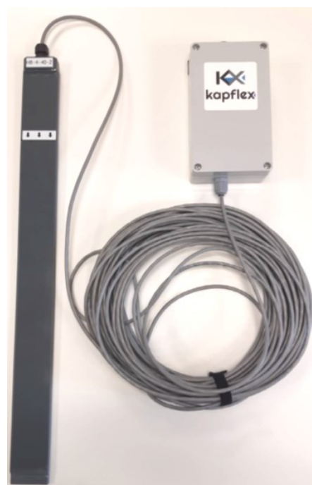
Prototype de la sonde Kapflex réalisée et connectée à son boîtier de contrôle (la sonde est présentée ici sans le flotteur)
