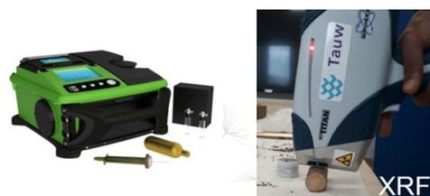
Appareils de mesure in-situ (GC-MS et XRF)
