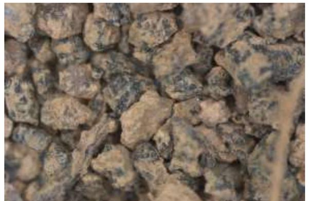
Photographie 2. Enrichissement en particules de sol de la surface de morceaux d'enrobé bitumineux après 1 an de présence dans le sol. © A. Herbreteau
