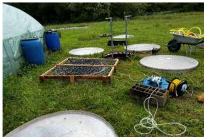
Figure 3: Opération de traçage KBr sur la colonne de bétons de granulométrie 0-80mm
